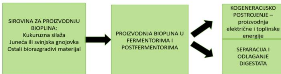
Slika 16. Shema procesa proizvodnje
