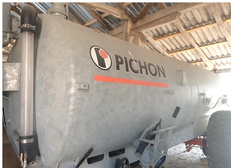
Slika 13. Spremnik za transport gnojovke na OPG-u Đuranec (Izvor: Vlastita fotografija)
