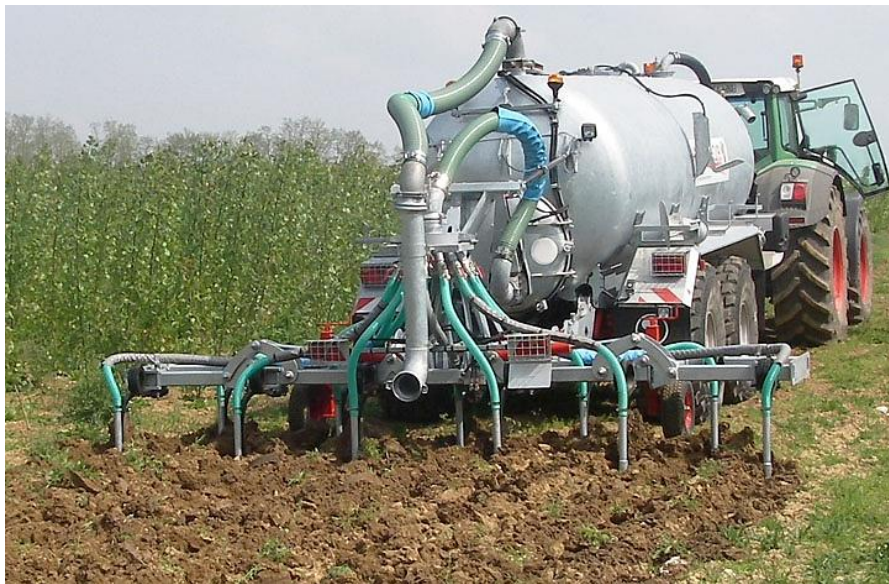
Slika 18. Uređaj za unošenje gnojovke u tlo (Izvor: Vlastita fotografija)
