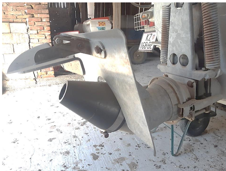
Slika 16. Sklop za dezintegraciju mlaza (Izvor: Vlastita fotografija)
