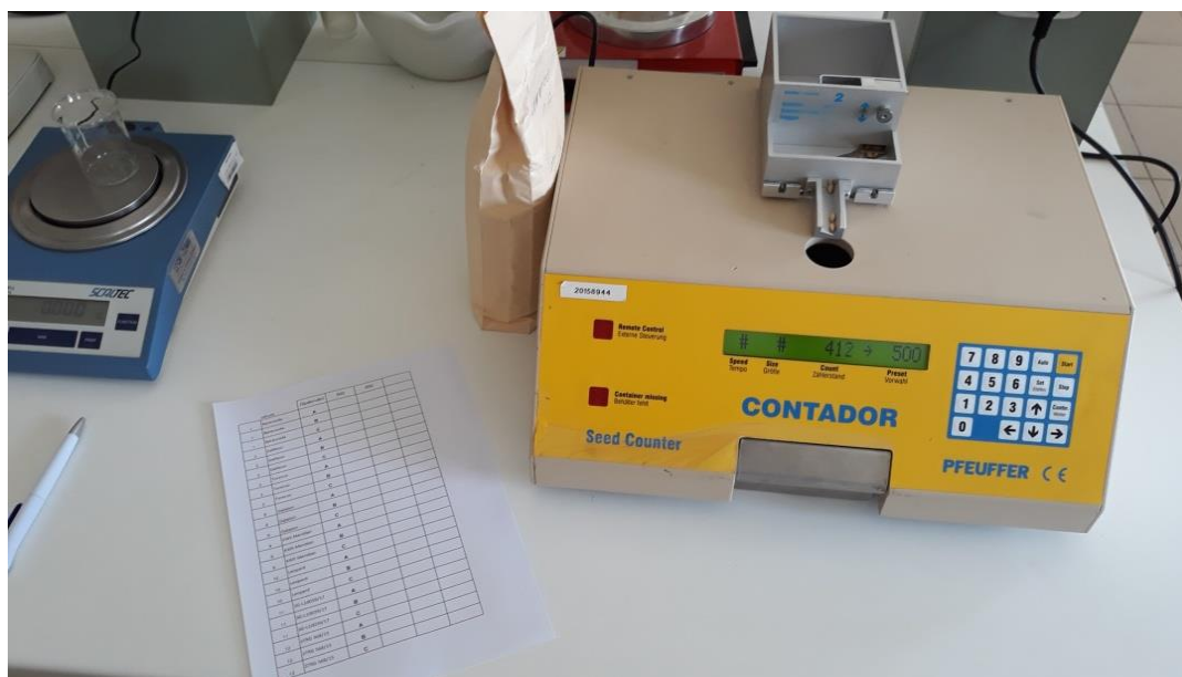
Slika 4. Brojanje zrna strojem Contador i određivanje mase 1000 zrna
