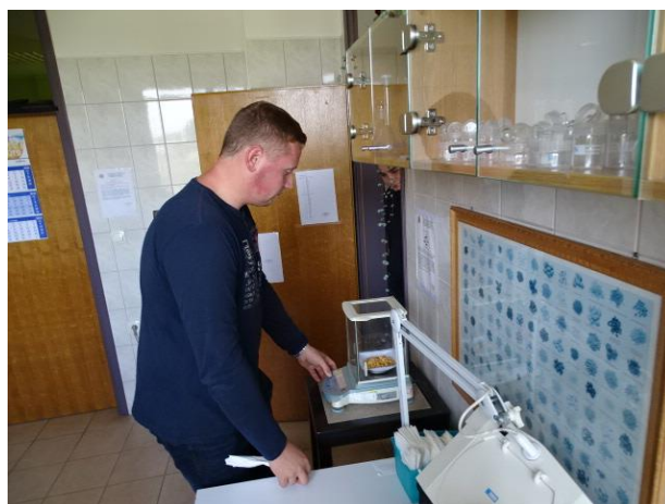
Slika 13. Vaganje 1000 zrna kukuruza
