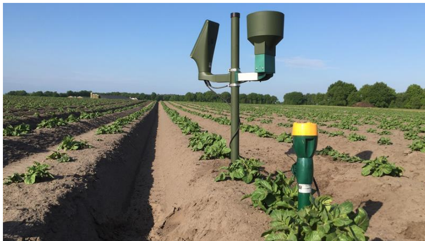
Slika 15. DACOM senzor za navodnjavanje u polju (Izvor: Van den Borne)
