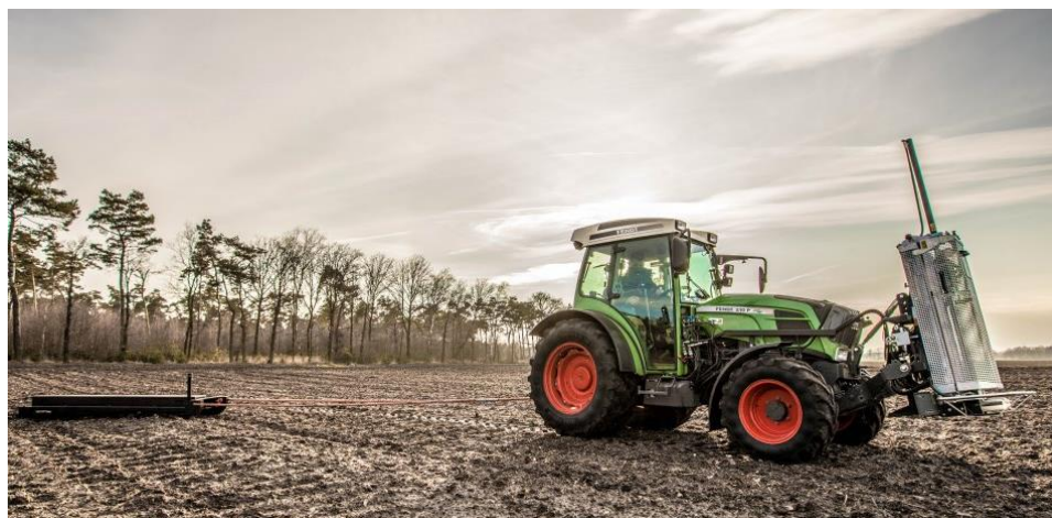
Slika 12. Mehanički skener tla i precizna sonda za uzorkovanje tla (Izvor: Van den Borne)
