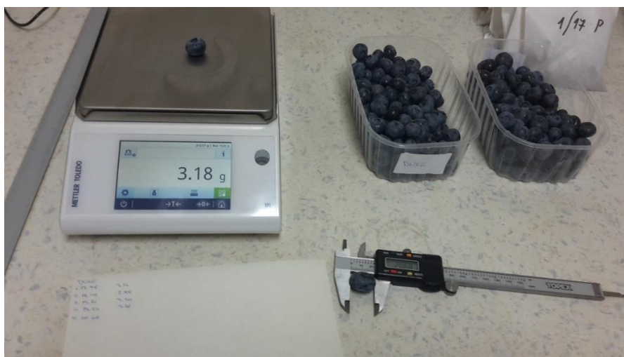
Slika 8 : Postupci pri mehaničkoj analizi ploda borovnice
