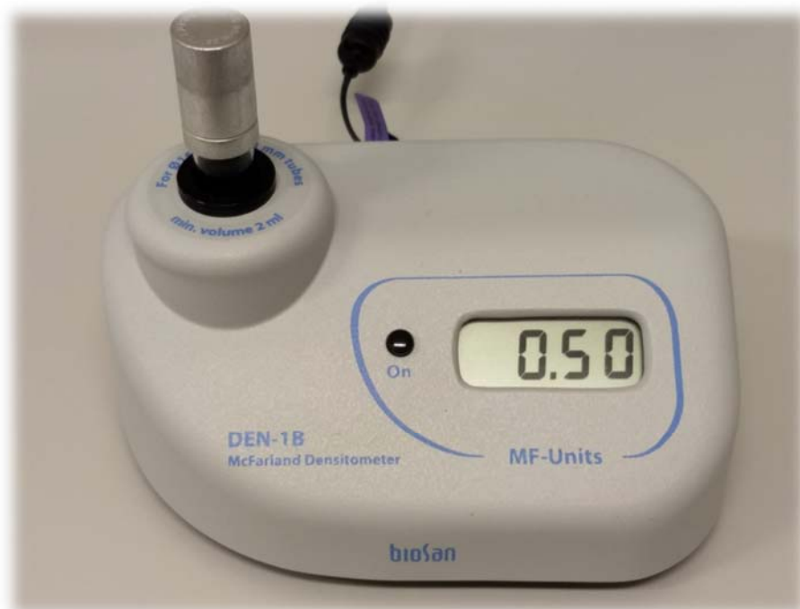
Slika 1. Densitometar – uređaj za mjerenje optičke gustoće suspenzije prema McFarlandu
