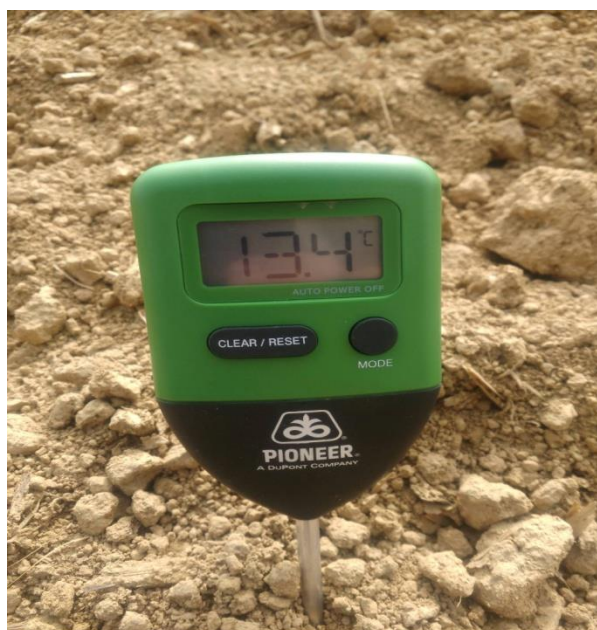
Slika 20. Uređaj za mjerenje temperature tla Izvor: Vlastita fotografija
