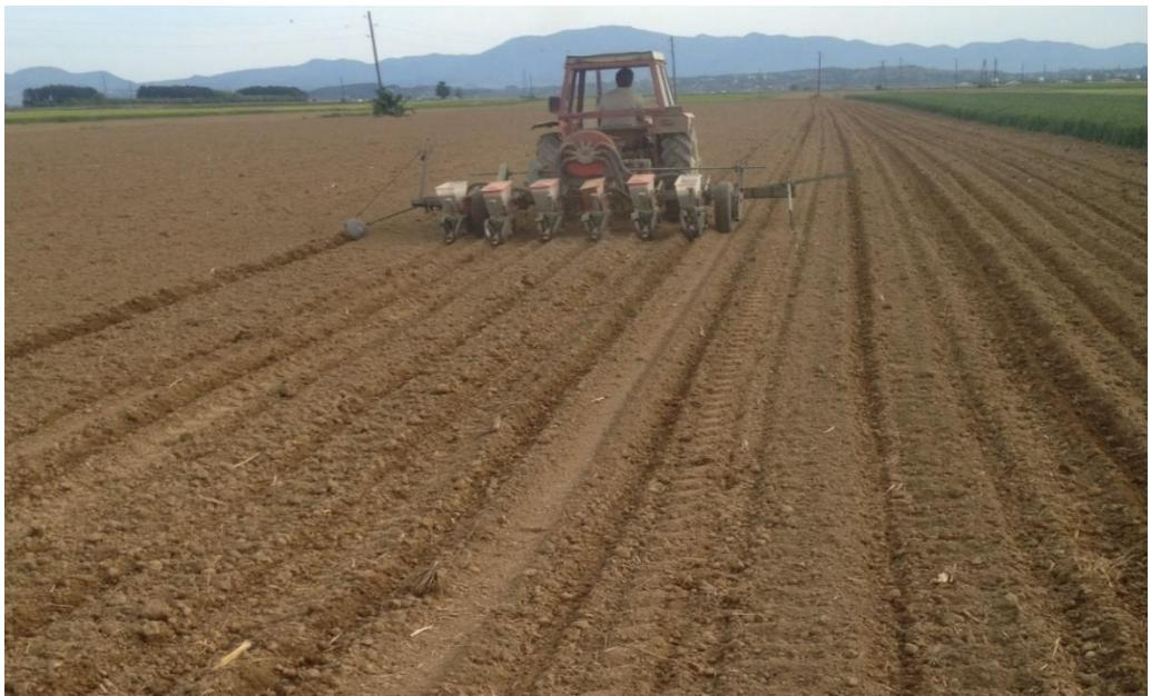
*Slika 3. Sjetva graha pomoću kombinacije traktora Massey Fergusona 135 i pneumatske sijačice OLT
