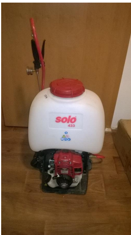
Slika 10: Leđna motorna prskalice (snimio: Fran Mesić)
