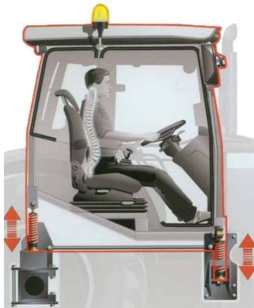
Slika 3. Shematski prikaz amortizacije kabine traktora
