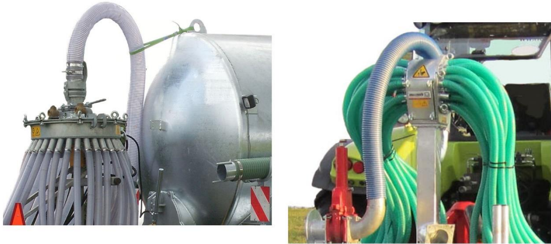
Slika 23. Prikaz sklopa za usmjeravanje mlaza
