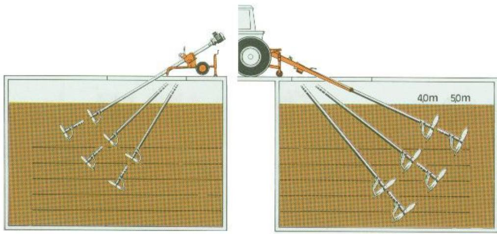
Slika 5. Shematski prikaz miješanja gnojovke vanjskim uređajima
