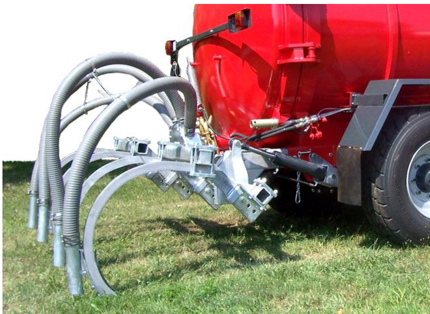
Slika 31. Prikaz raoniočnog ulagača gnojovke
