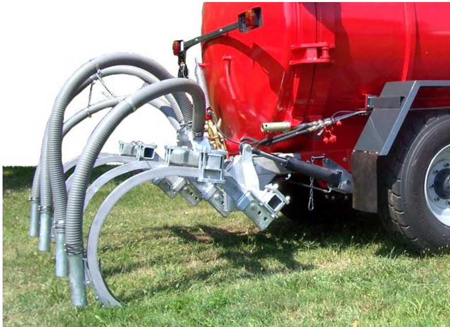
Slika 31. Prikaz raoniočnog ulagača gnojovke
