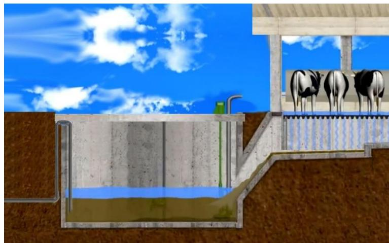
Slika 3. Shematski prikaz podzemnog spremnika za gnojovku
