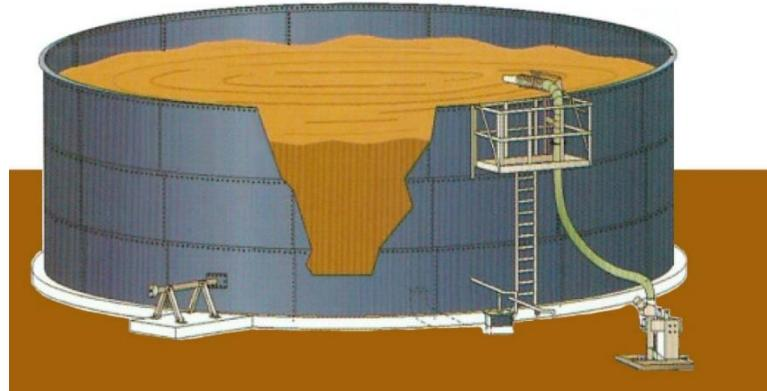
Slika 1. Shematski prikaz nadzemnog spremnika za gnojovku
