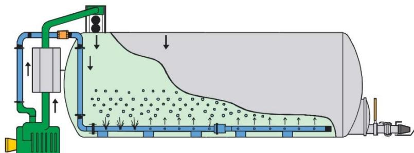
Slika 16. Shematski prikaz hidrauličnog načina miješanja gnojovke
