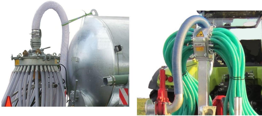
Slika 23. Prikaz sklopa za usmjeravanje mlaza
