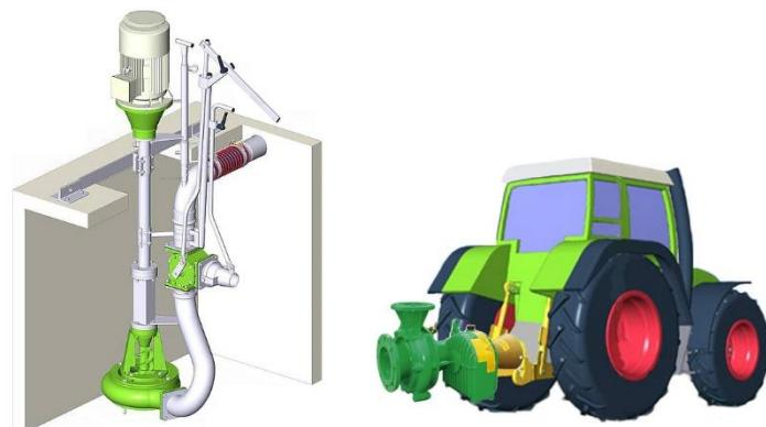
Slika 9. Shematski prikaz crpki za transport gnojovke
