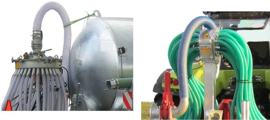
Slika 23. Prikaz sklopa za usmjeravanje mlaza
