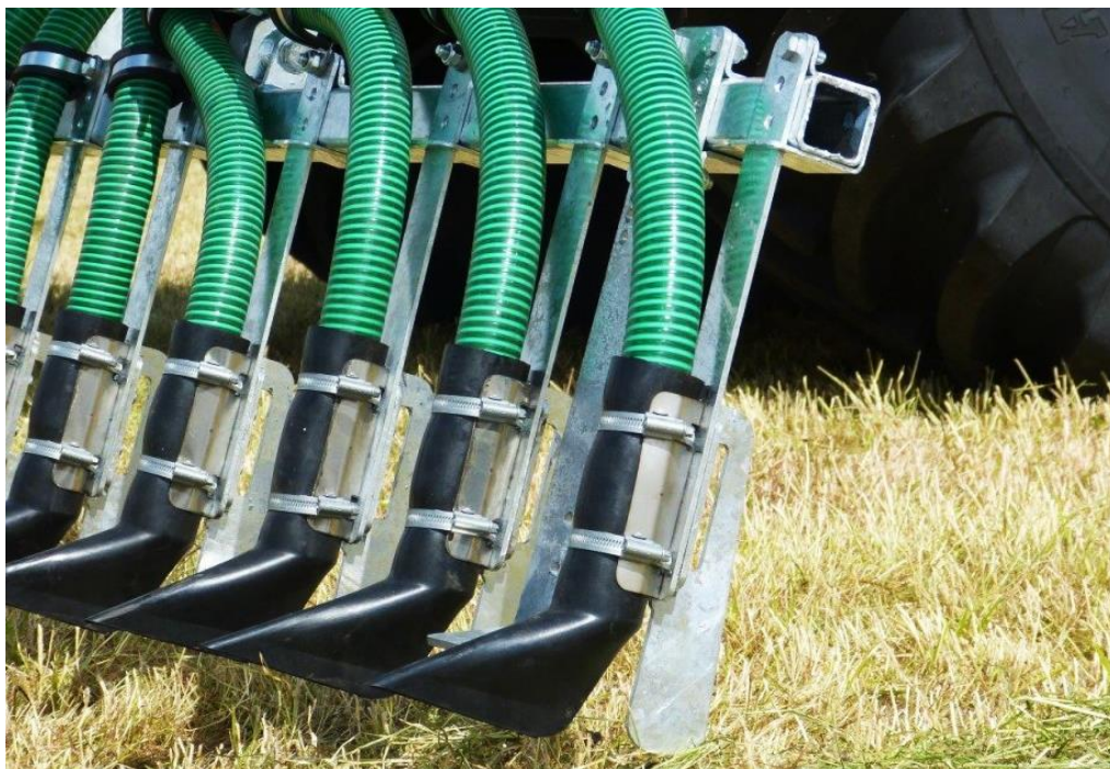
Slika 32. Prikaz raoniočnog ulagača gnojovke
