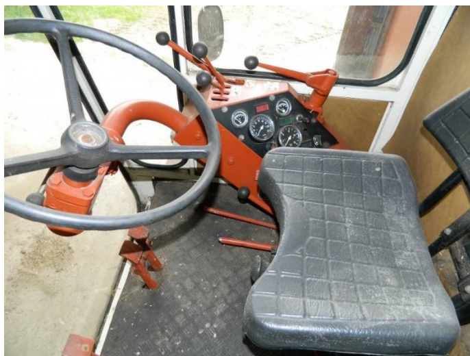
Slika 9. Prikaz unutrašnjosti kabine kombajna Fiat Laverda 3300 AL
