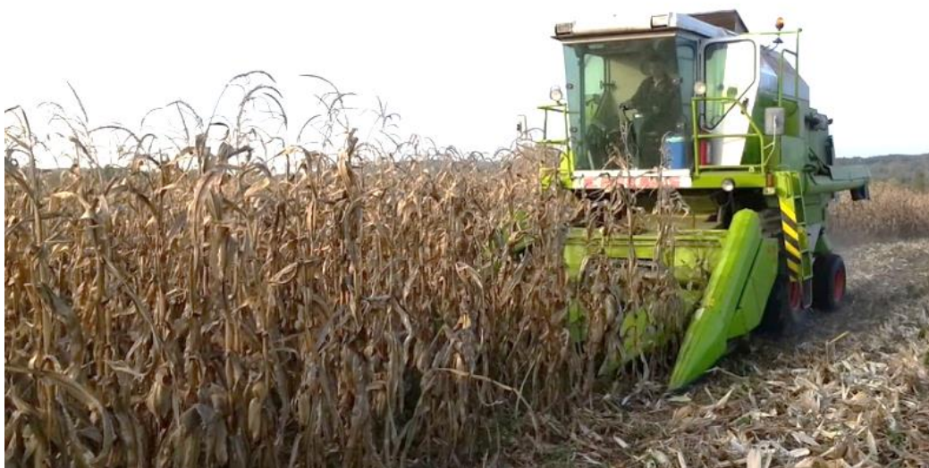
Slika 2. Berač - komušać suhog klipa kukuruza
