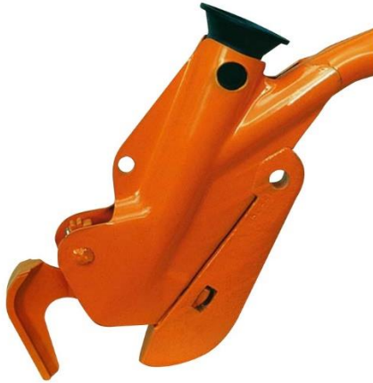
Slika 4. Sijači ulagač u obliku raonika tvrtke Amazone (Izvor: V. Miloš)
