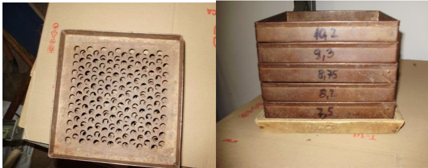
Slika 1. Sita različitih veličina za prosijavanje i određivanje krupnoće zrna graška
