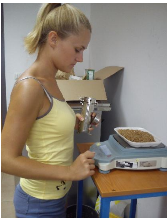
Slika 5 i 6. Određivanje hektolitarske mase
