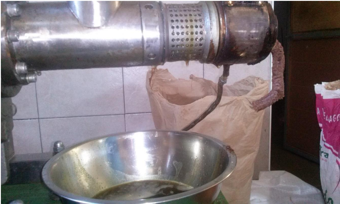
Slika 13: Postupak hladnog prešanja ulja iz sjemenki grožđa
