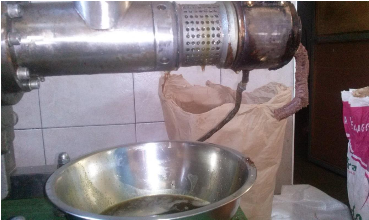
Slika 13: Postupak hladnog prešanja ulja iz sjemenki grožđa
