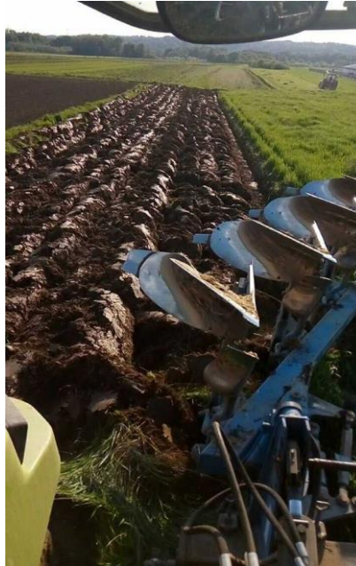
Slika 3: Suvremeni plug premetnjak
