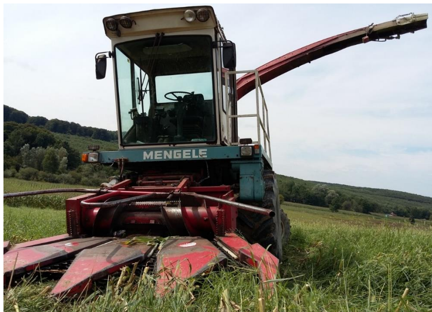
Slika 13: Samohodni silokombajn MENGELE
