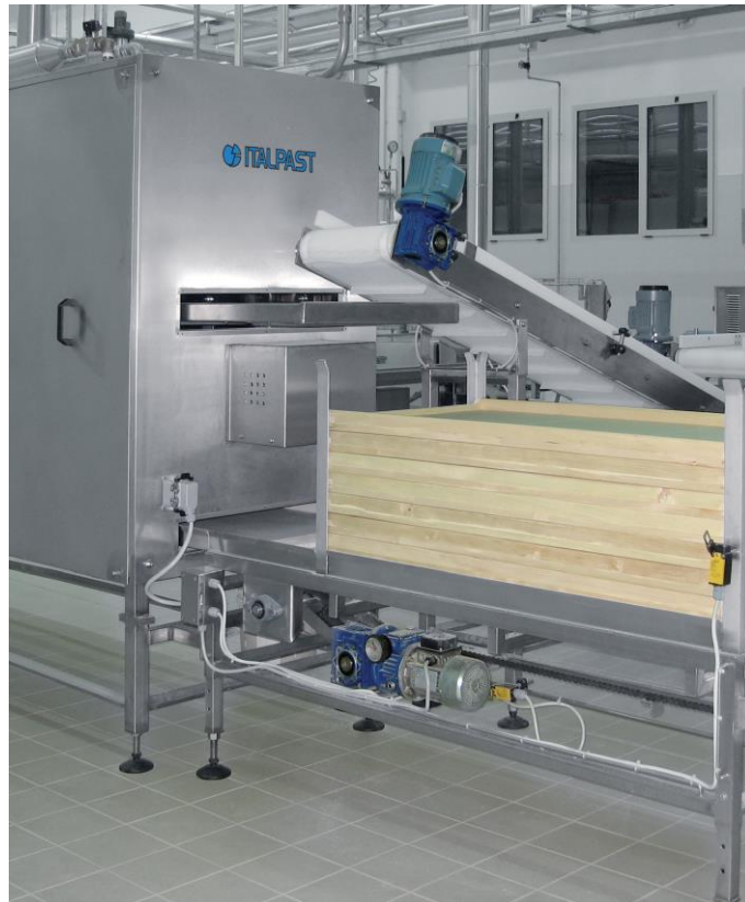
Slika 7. Automatski stroj za punjenje ramica mod. MT Izvor: Internet stranica http://www.italpast.it/
