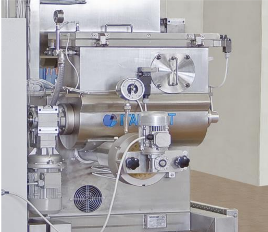
Slika 4. Oprema za vakuumiranje tjestenine uz ekstruder MAC 220
