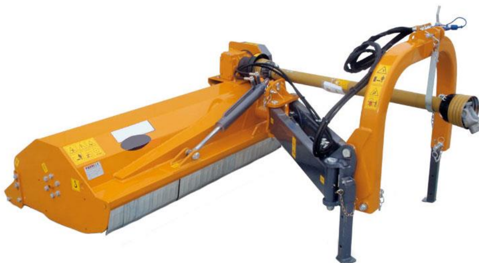
Slika 6. Uređaj sa sklopom za regulaciju položaja Izvor: M. Šešelj
