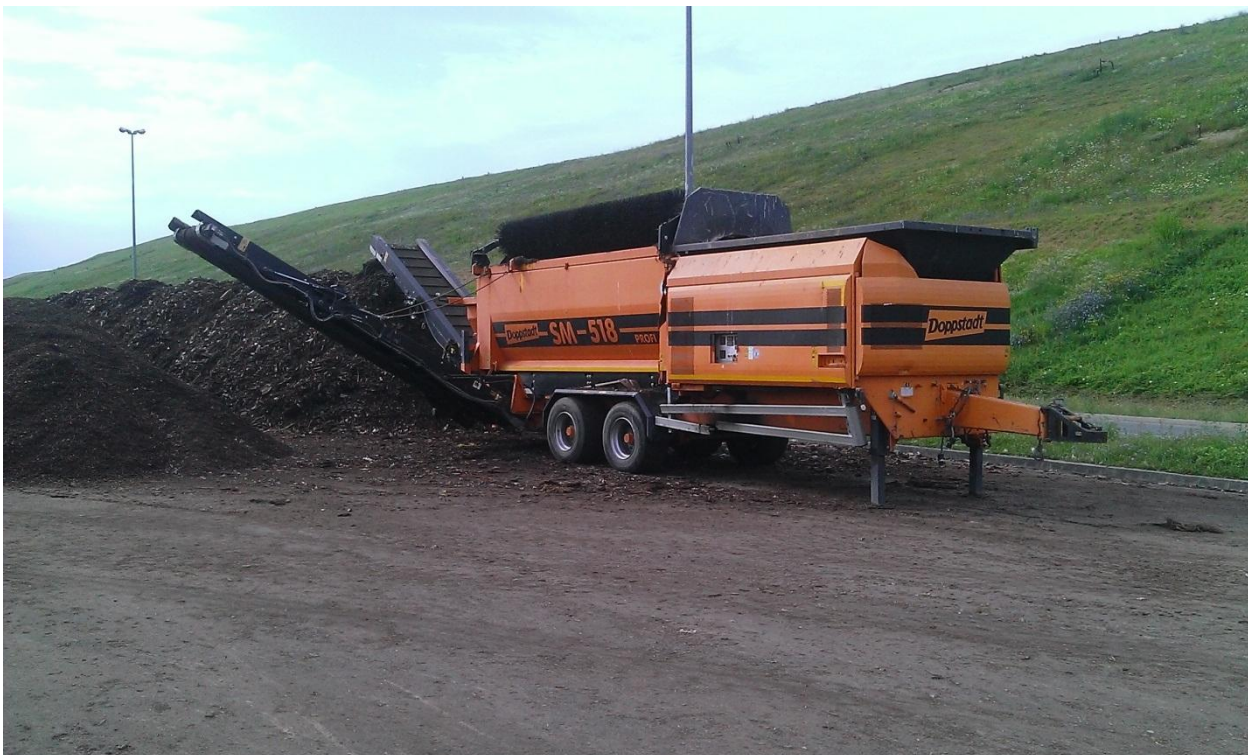
Slika 13. „Doppstadt SM-518“ stroj za prosijavanje komposta
