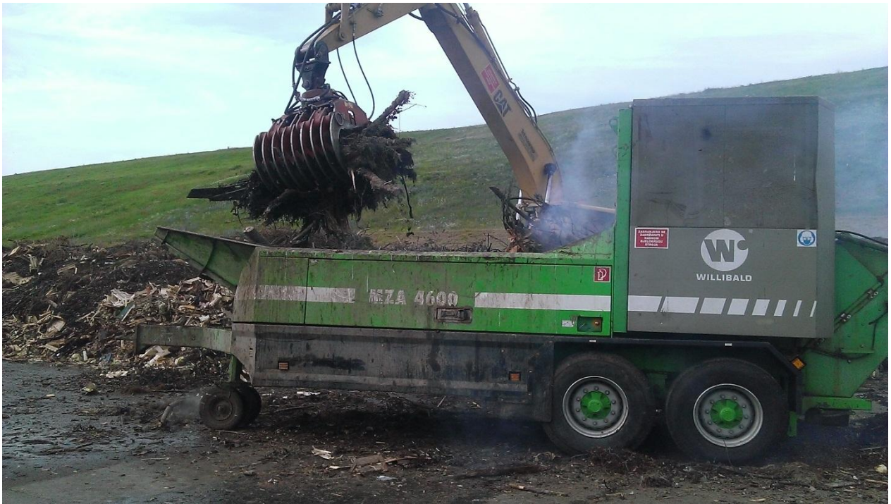
Slika 8. Utovar i mljevenje drobilicom Willibald-MZA-4600
