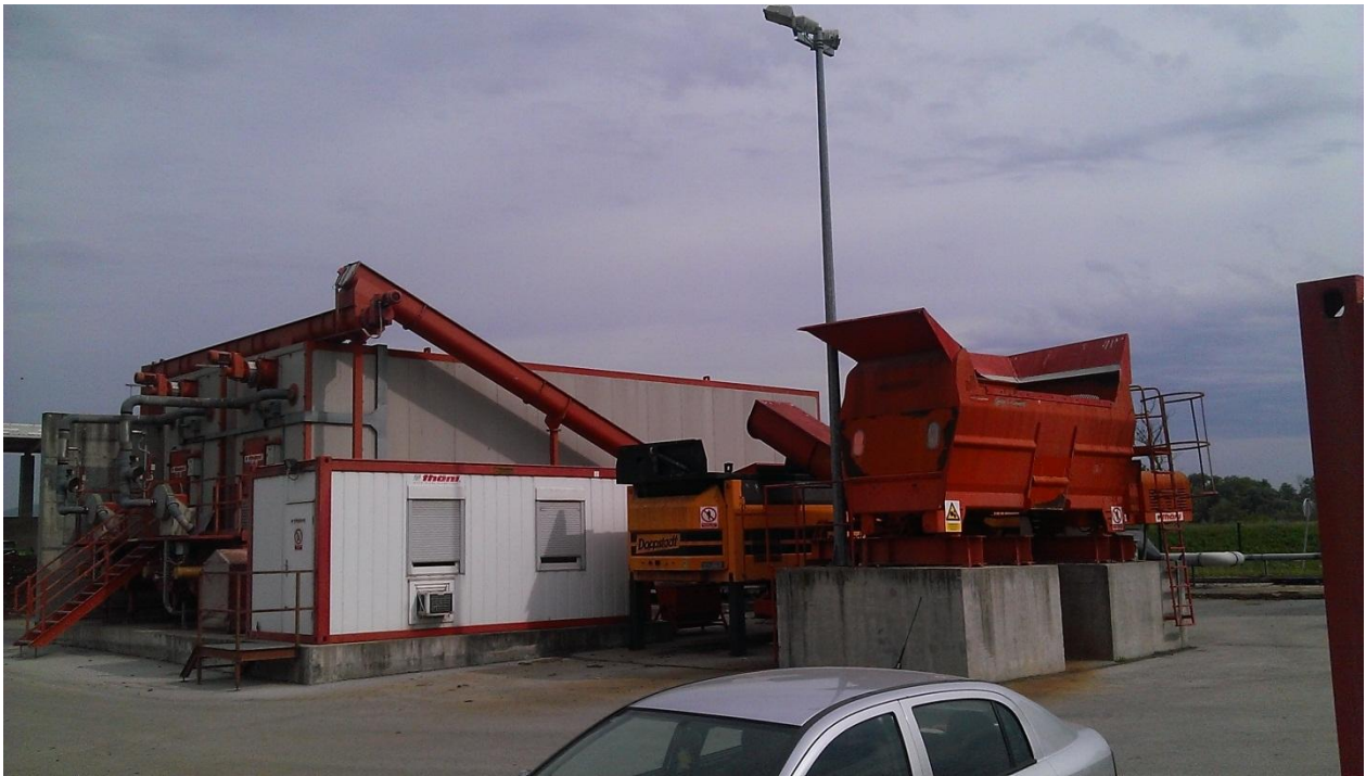
Slika 15. Zatvoreni tip kompostane (server soba, drobilica i sito)
