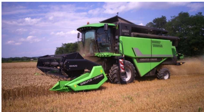
Slika 8. Kombajn, Deutzfah 6060 HTS
