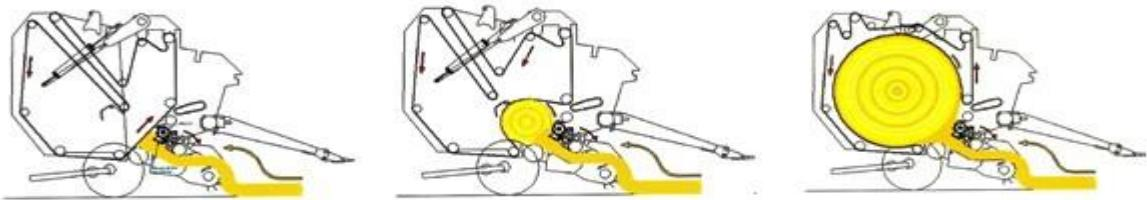
Slika 11. Princip rada preše s elastičnom tlačnom komorom
