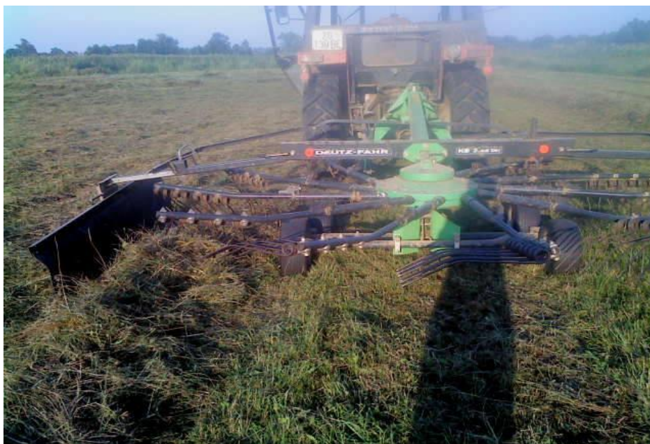
Slika 20. Sakupljač provenute mase marke DEUTZ FAHR u radu
