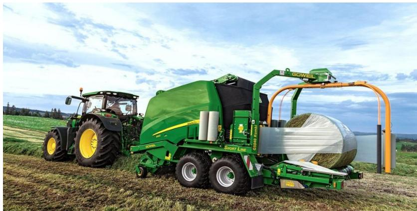
Slika 14. Preša i omotač u jednom stroju
