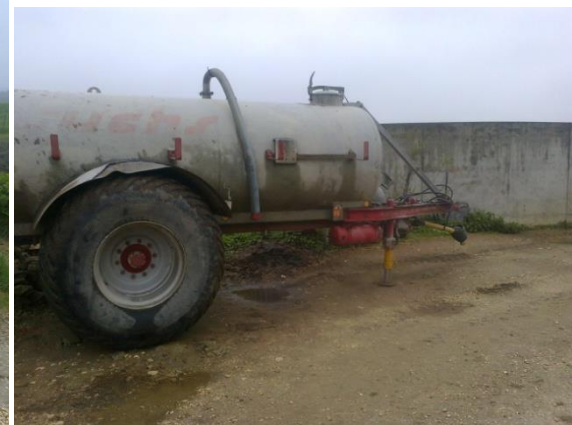
Slika 19. Cisterna za gnojnicu
