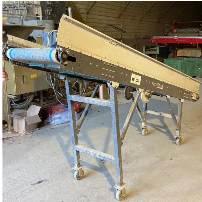
Slika 25. Transportna traka tipa „labud“ marke Pro-Vega
