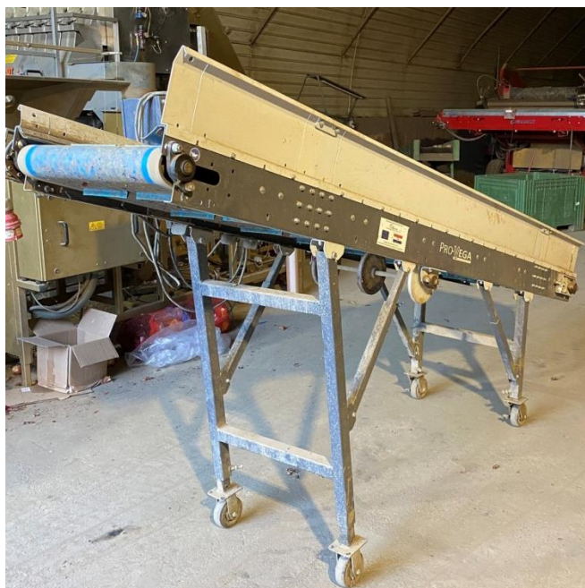
Slika 25. Transportna traka tipa „labud“ marke Pro-Vega
