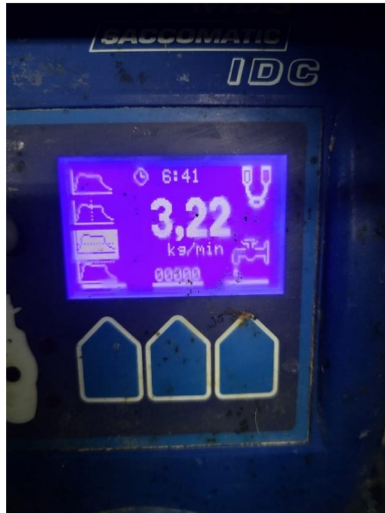
Slika 16. Uređaj za nadzor mužnje - pokazuje protok mlijeka u minuti
