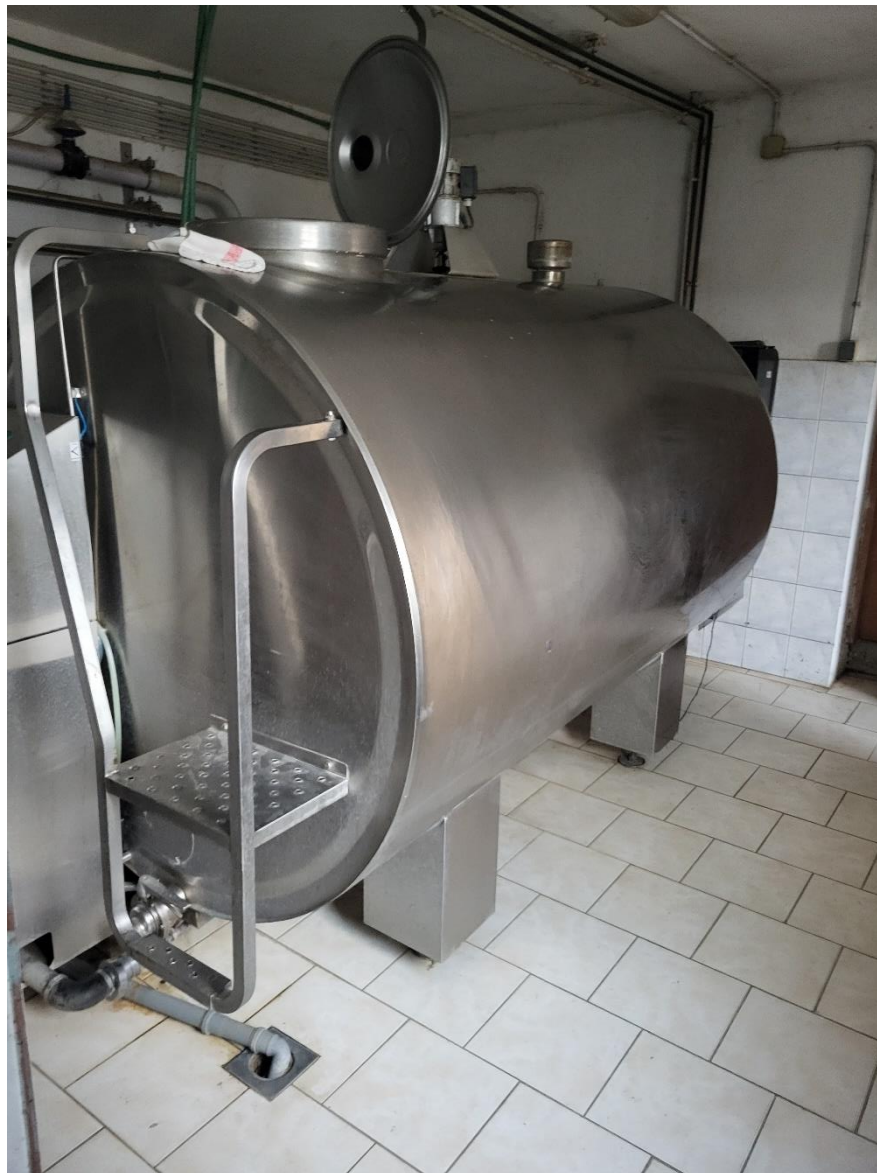
Slika 10. Rashladni uređaj za mlijeko
